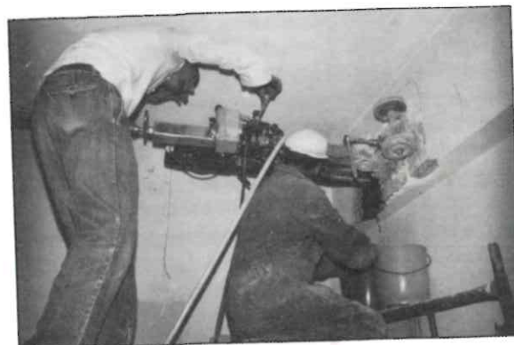
Corte de probeta testigo, mediante sonda, en soporte de hormigón armado.
