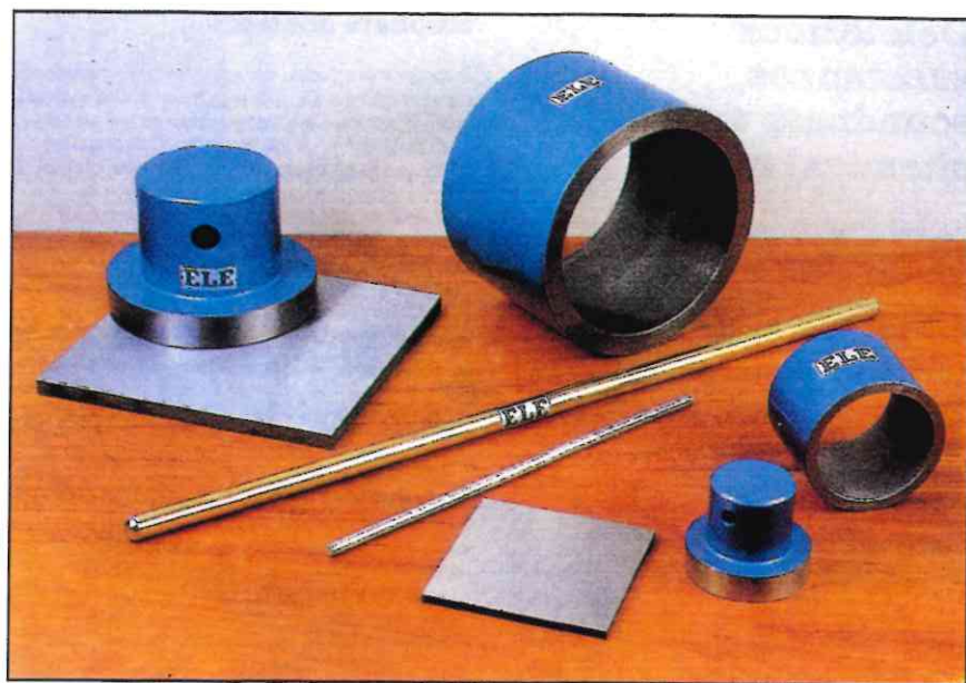
Figura.1.- Utensilios para el ensayo de friabilidad estática de áridos
