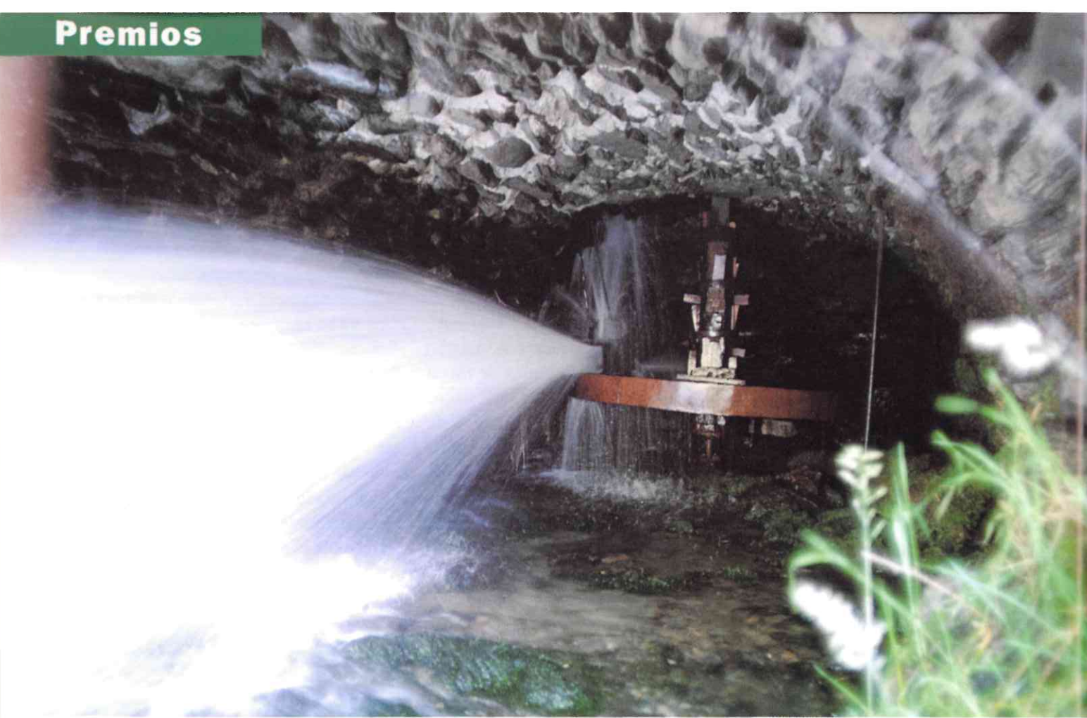
Rodezno del Molino de Carmelo (Jérez del Marquesado) con la 'paraera' bajada y dispuesto para funcionar.
