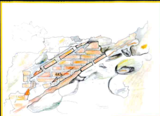
[Fig. 11] Detalle de una canalización interior de agua embutida en el muro
