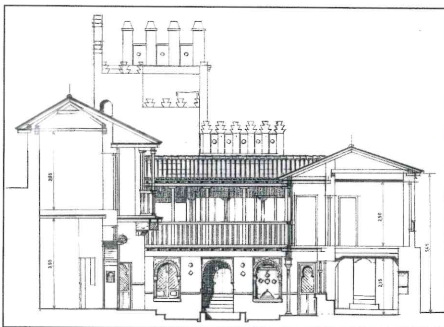
Sección C-C. Estado previo
