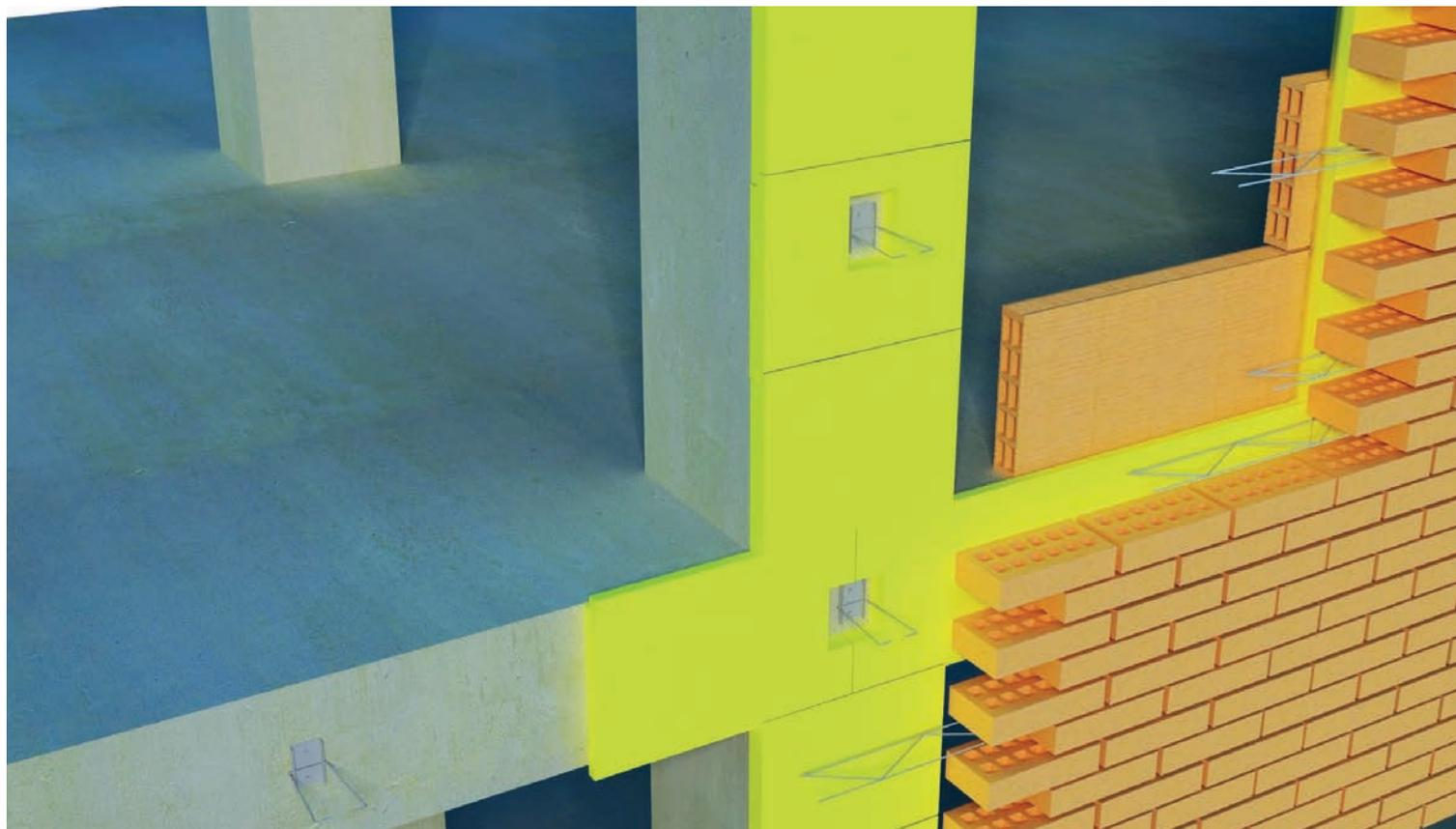
Figura 5. Solución de fachada G.H.A.S.® de ladrillo cara vista para EECN y PASSIVHAUS
