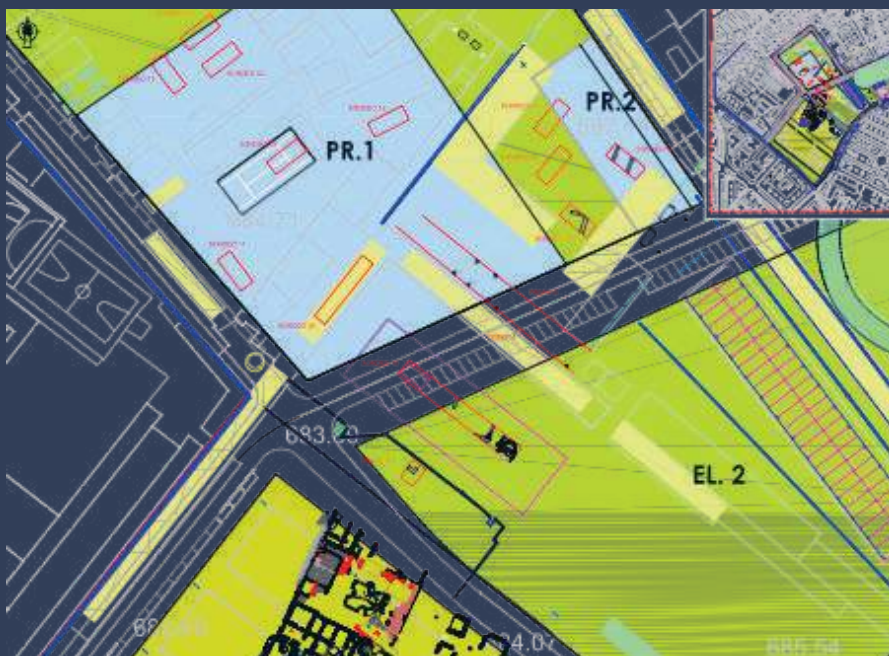
Figura 13. Plano de los sondeos de la campaña de auscultación (2016) en el marco del PERI.
