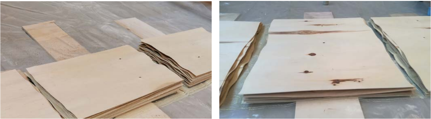
CHAPA DE ALTA CALIDAD USADA PARA LOS PANELES Q1 CHAPA DE BAJA CALIDAD PARA LOS PANELES Q2
