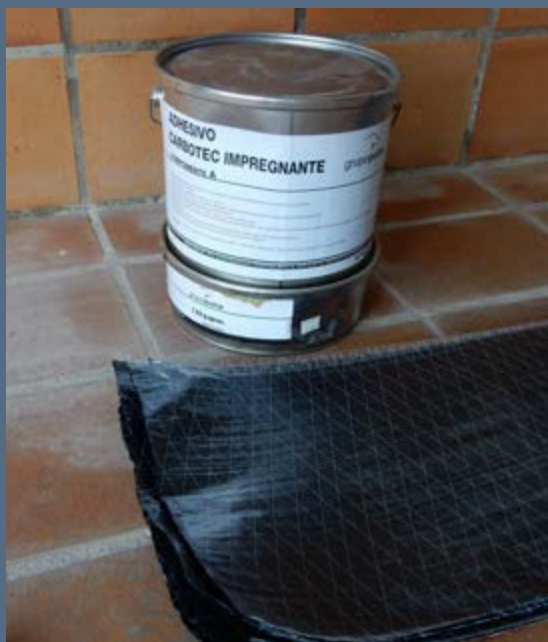
Ilustración 8. Amasado y aplicación del adhesivo Carbotec impregnante.
