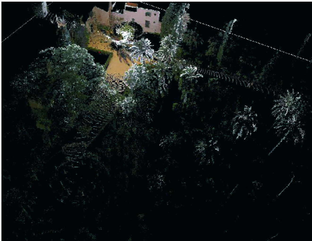
Figura 2. Nube de puntos resultante de un escaneado de 360°. Elaboración propia a partir de nube de puntos gentileza de Riegl Measurement Systems GmbH
