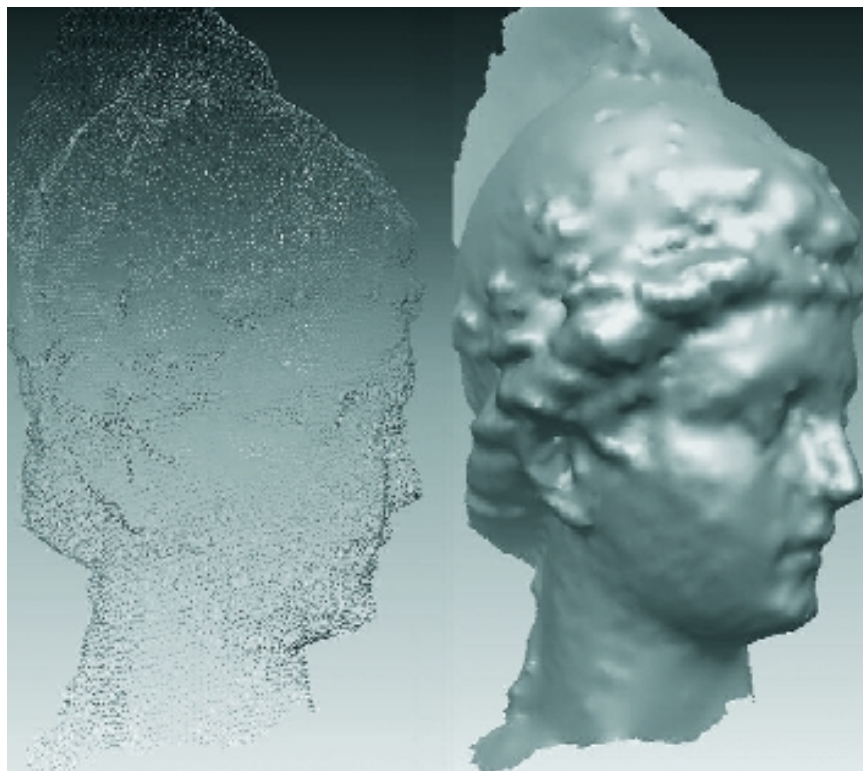
Figura 8. Nube de puntos y modelizado de la misma mediante triangulación 3D semiautomática. Elaboración propia.
